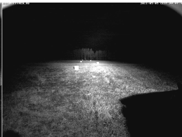
ОБЛАСТЬ, ОСВЕЩАЕМАЯ ПРИ НАПРАВЛЕНИИ ПРОЖЕКТОРОВ В ОДНУ ТОЧКУ
